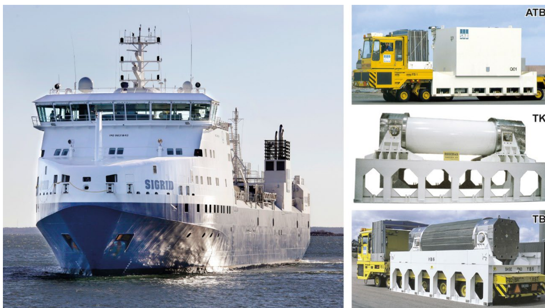
Figur 2-8. SKB:s transportsystem utgörs idag av ett fartyg (m/s Sigrid), terminalfordon samt avfallstransportbehållare (ATB) för kortlivat radioaktivt avfall, behållare för hårdkomponenter (TK), och använt kärnbränsle (TB).
