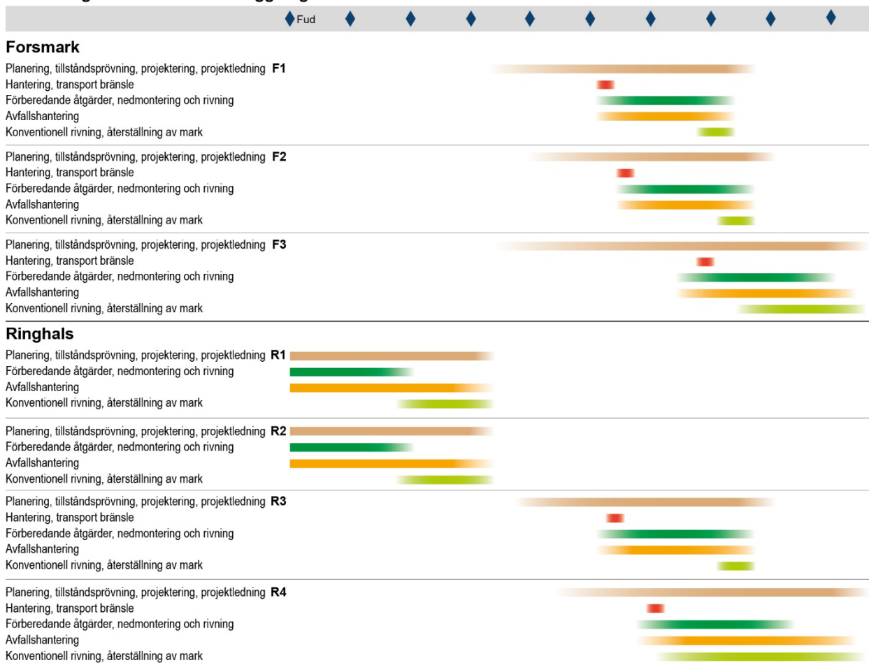
Figur 2-13. Principiell översikt av Forsmarks Kraftgrupp AB:s respektive Ringhals AB:s planer för avveckling.
